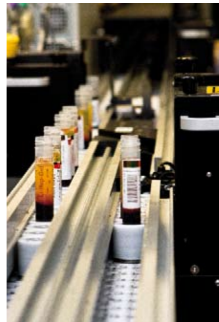
Das Förderband bringt die Proben zu den Geräten der Laborautomation.
